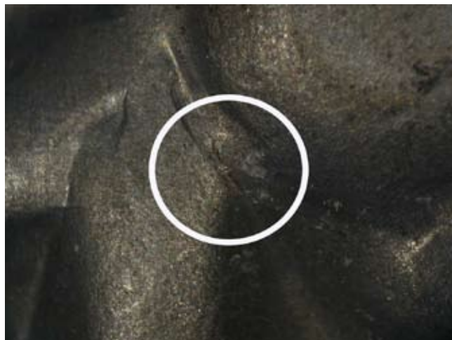
Snímek trhliny v desce výměníku způsobené použitím těsnění, jehož tloušťka je o 12% větší než uvádí specifikace. Použitím takového těsnění došlo k vytvoření velké vzdálenosti mezi první a poslední deskou výměníku.
